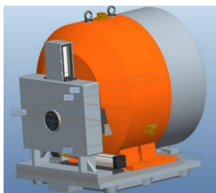
图 9-5 多源辐照装置结构示意图
